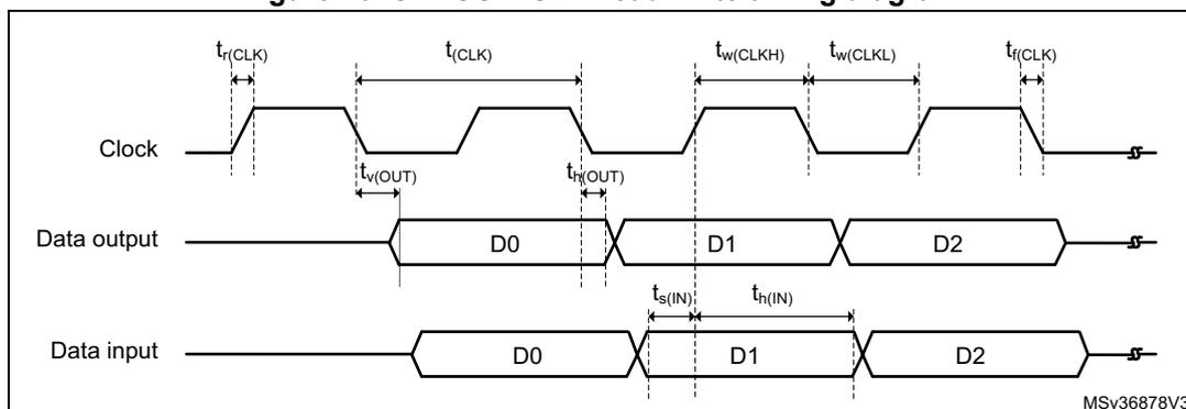
Table 86. OCTOSPI characteristics in DTR mode (no DQS)<sup>(1)(2)(3)</sup>
