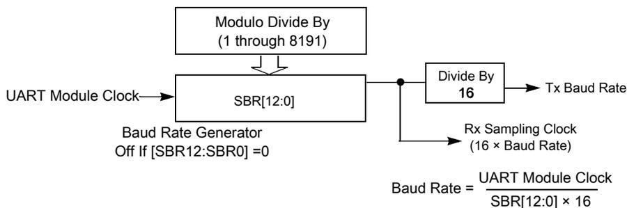
**Figure 33-3. UART baud rate generation**
